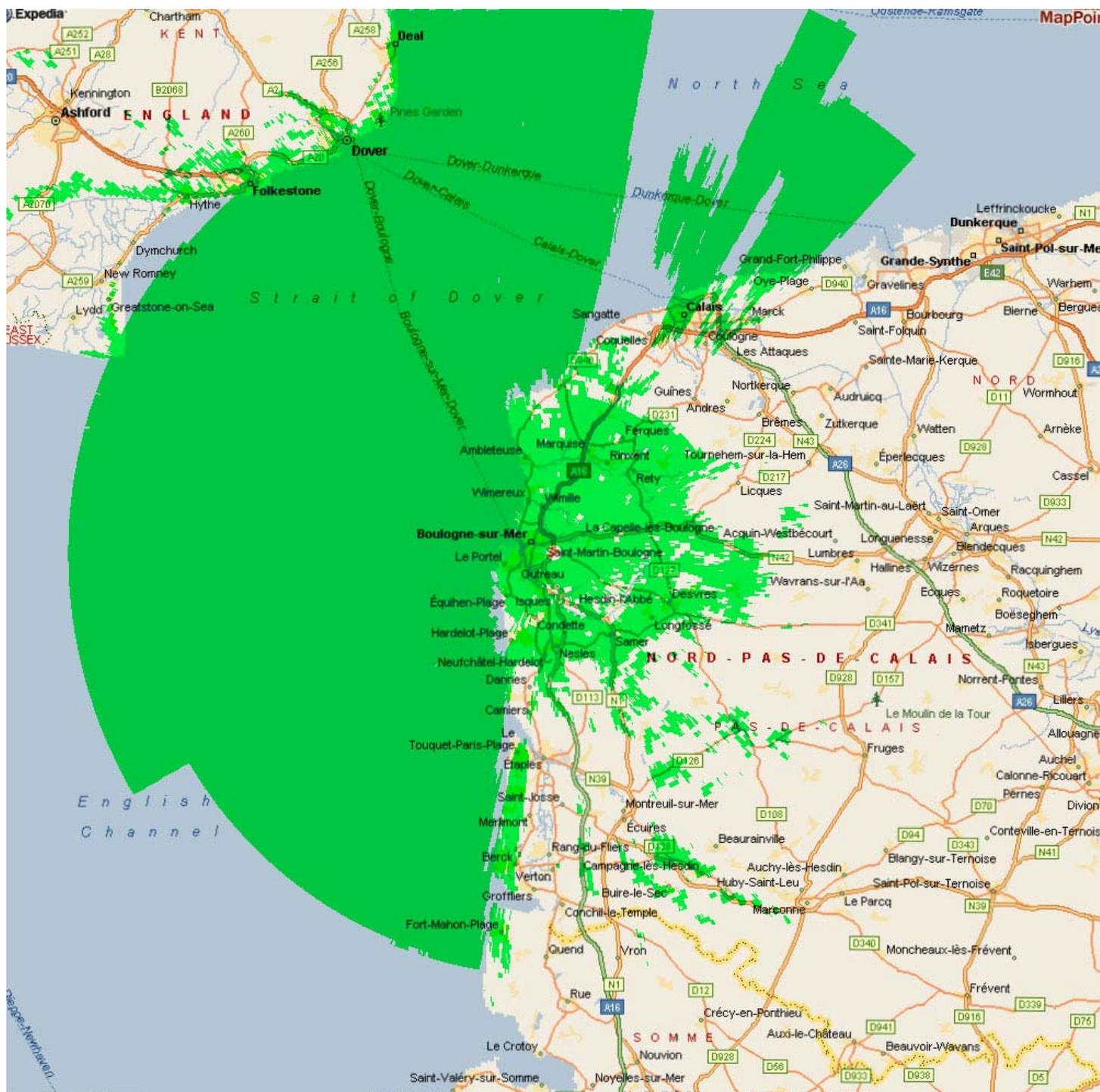
Ceci est une carte prévisionnelle non officielle, calculée à l'aide d'un logiciel, la couverture verte représente une force de signal  $> 54 \text{ dB}\mu\text{V}$  reçu par une antenne à 10m du sol.
