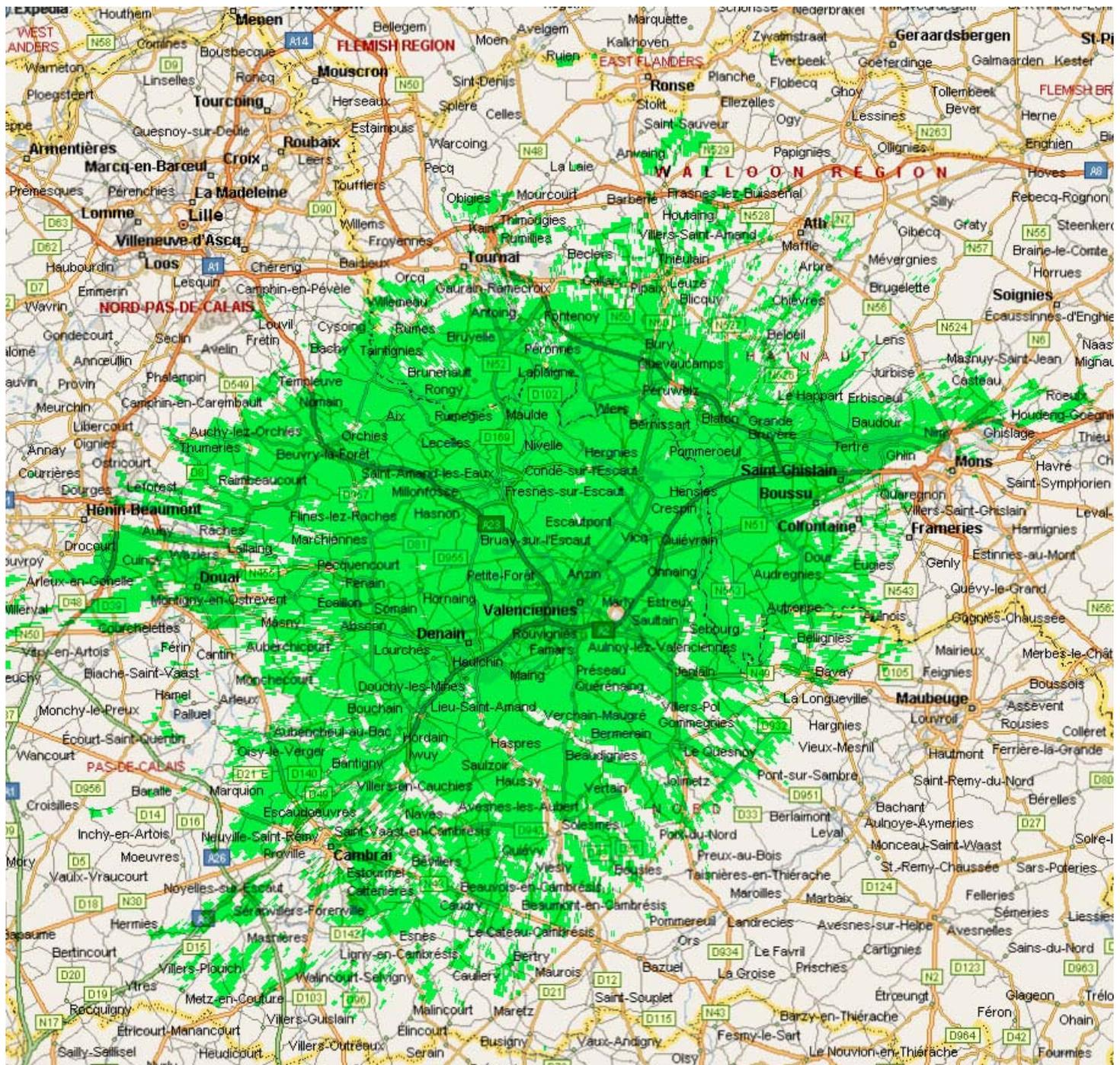
Ceci est une carte prévisionnelle non officielle, calculée à l'aide d'un logiciel, la couverture verte représente une force de signal > 54 dBμV reçu par une antenne à 10m du sol.
